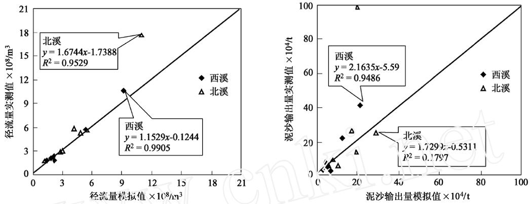
图 4 九龙江西溪和北溪流域地表径流和泥沙输出模拟值与实测值拟合比较
