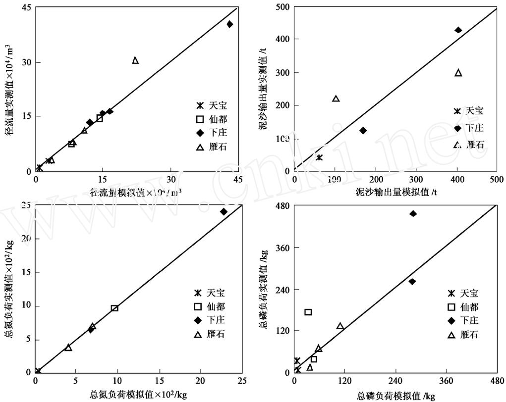
图3 九龙江典型汇水区地表径流、泥沙输出、总氮和总磷模拟值与实测值拟合比较
