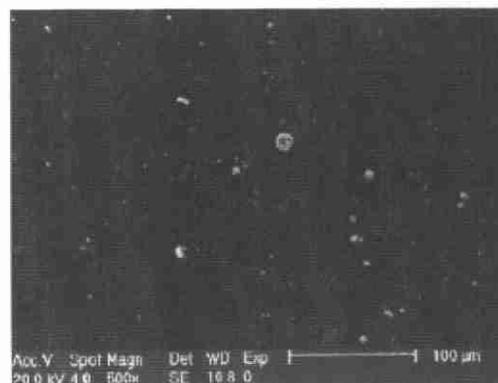
图6 反冲洗后的膜表面(4mg/L混凝液)
