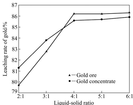
图 6 液固比对浸出效果的影响
