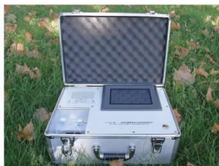
图 1 便携式倏逝波全光纤生物传感平台结构示意图及实物
