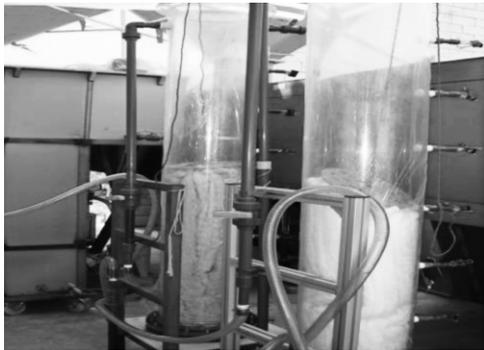
图 3 雨水径流污染控制中试设备
