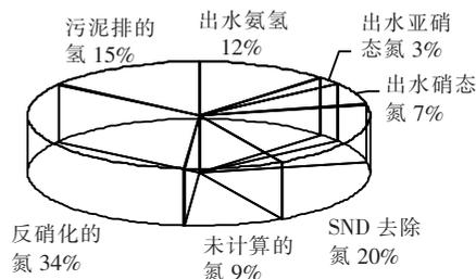
图 5 微膨胀状态下氮元素的物料平衡(质量组成)
