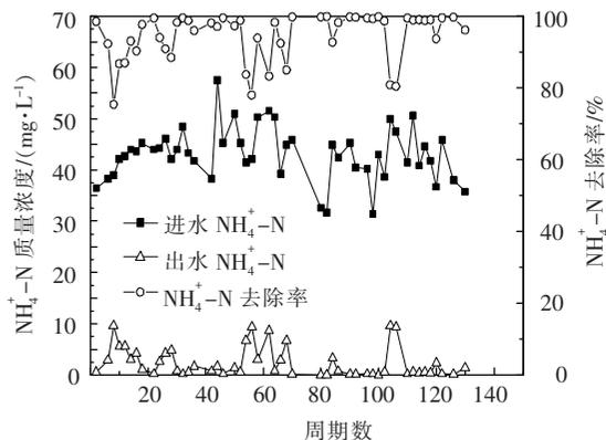
图 4 污泥微膨胀期间的氨氮去除效果
