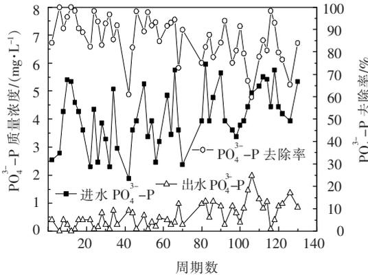
图7 微膨胀状态下的正磷去除效果
