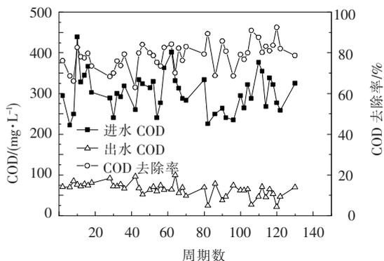
图 6 微膨胀状态下 COD 去除效果
