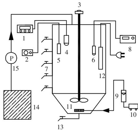
1—DO 仪;2—pH 计;3—调速器;4—DO 探头;5—pH 探头;6—ORP 探头;7—取样口;8—ORP 仪;9—转子流量计;10—曝气泵;11—曝气头;12—加热棒;13—放空阀;14—贮水箱;15—蠕动泵.
