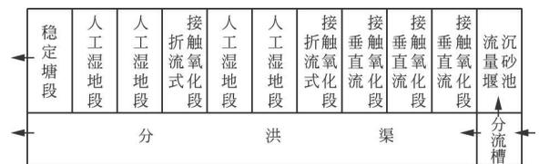
图1 强化沟渠的工艺示意
