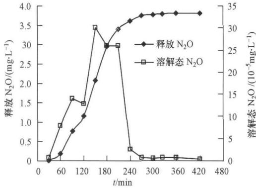
图3 B反应器一周期内 N<sub>2</sub>O的释放和溶解量变化规律
