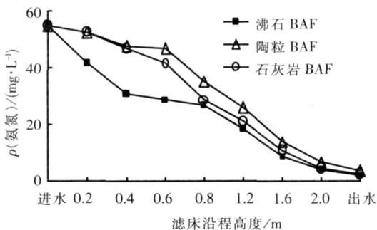
图 3 3种填料曝气生物滤池氨氮浓度的沿程分布
