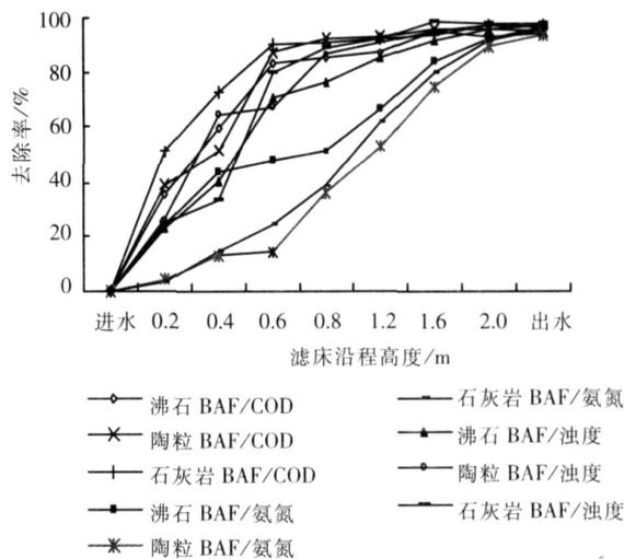
图 4 曝气生物滤池 COD、SS和氨氮去除率的沿程变化
