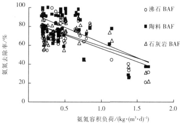
图 6 进水氨氮负荷对曝气生物滤池氨氮去除率的影响
