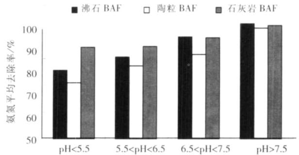
图 7 进水 pH 对不同填料曝气生物滤池氨氮去除率的影响
