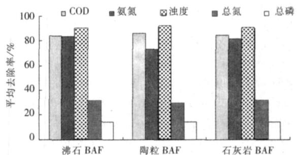
图 1 3 种填料曝气生物滤池的处理效能对比
