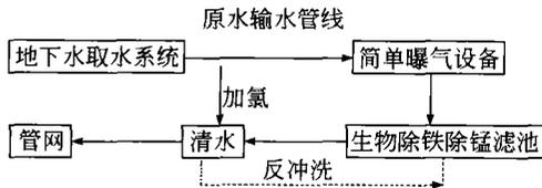
图8 生物除铁锰成套系统工艺流程图
