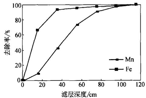
图5 滤柱不同深度铁锰去除率
