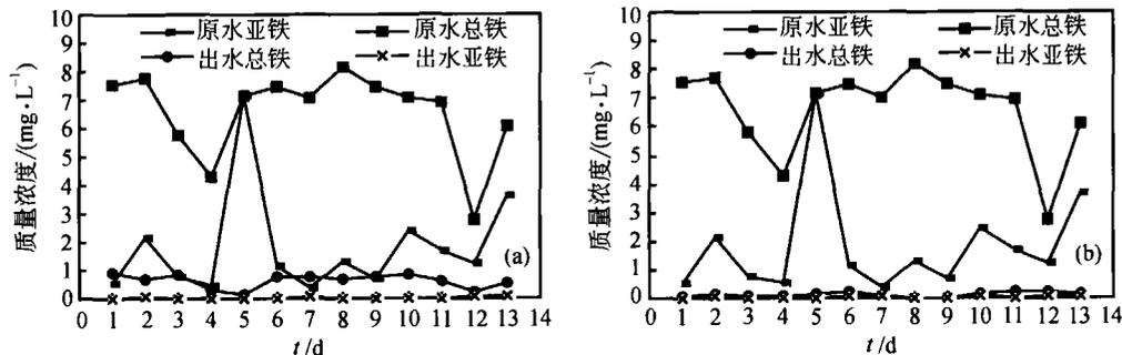
图6 无菌滤柱和生物滤柱单铁过滤
