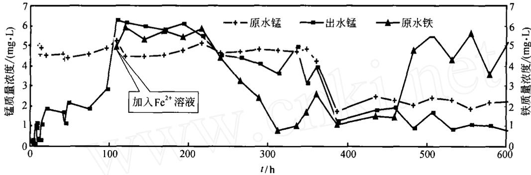
图7 Fe<sup>2+</sup>对成熟锰砂滤柱除锰效果的影响
