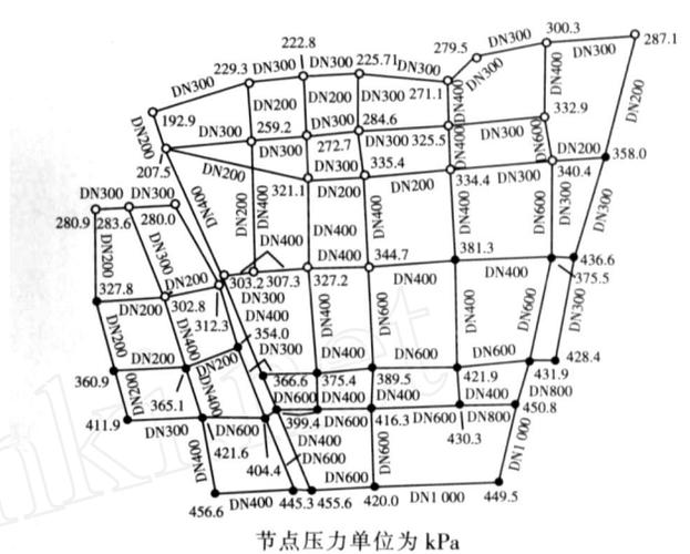
图 3 再生水管网计算结果(部分)
