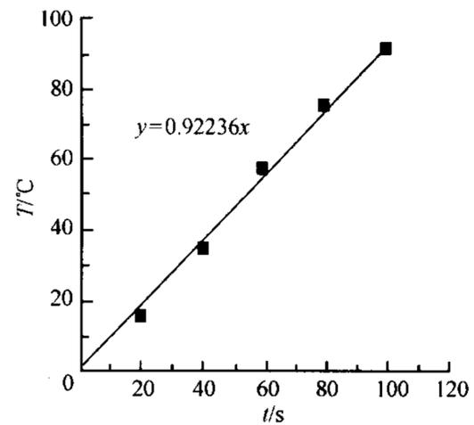
图 1 150mL 菌悬液在 900W 连续微波场中温度变化曲线
