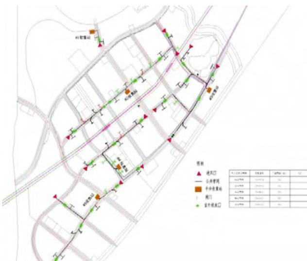
图1 生态城气力输送布局
