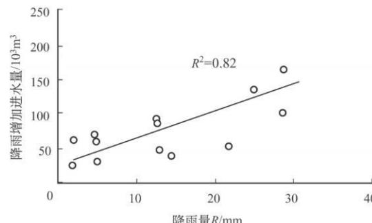
图 5 降雨量与雨后污水处理厂进水增加量的关系
