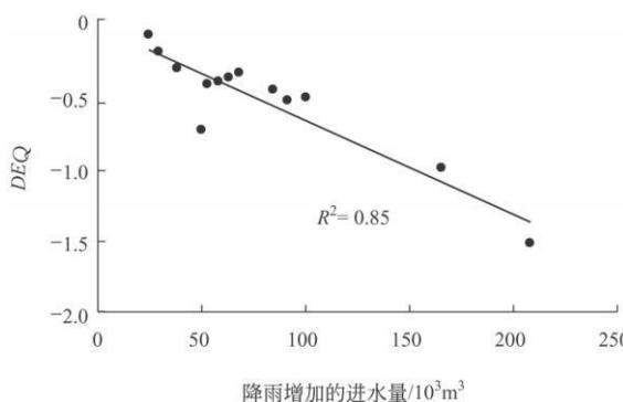
图 6 降雨后进水量增加量与出水污染程度变化指数的关系
