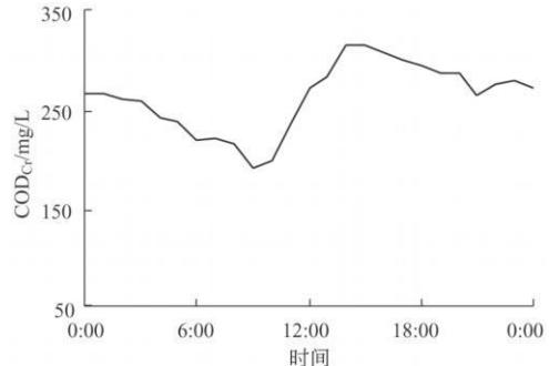
图 3 进水 COD<sub>r</sub> 的日内时变化规律
