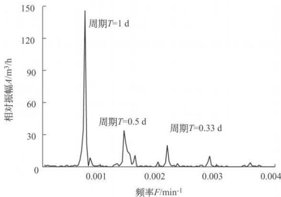
图 1 进水水量动态变化的频谱分析结果
