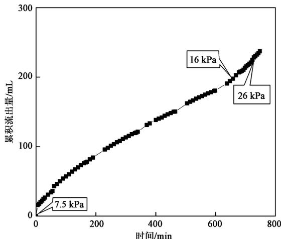
图 10 混有保水剂垃圾样品累积出流量-时间关系
