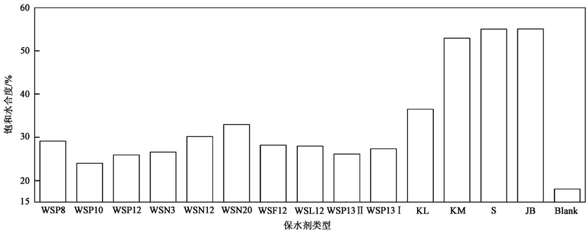
图 1 保水剂混合砂饱和水合度比较
