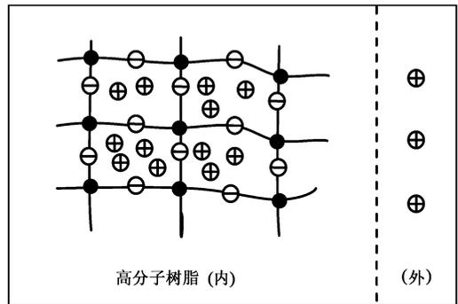
图 2 高分子吸水树脂交联网络结构模型
