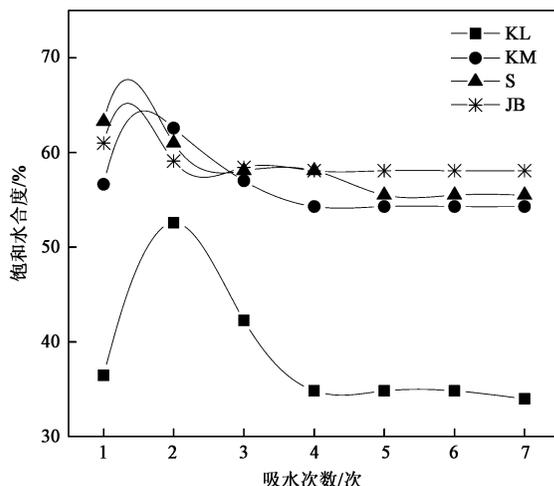
图 7 粒径对非水溶性 PAM 吸水能力影响
