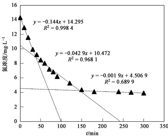
图5 油脂 NUR 曲线图(125 mg L<sup>-1</sup>)
