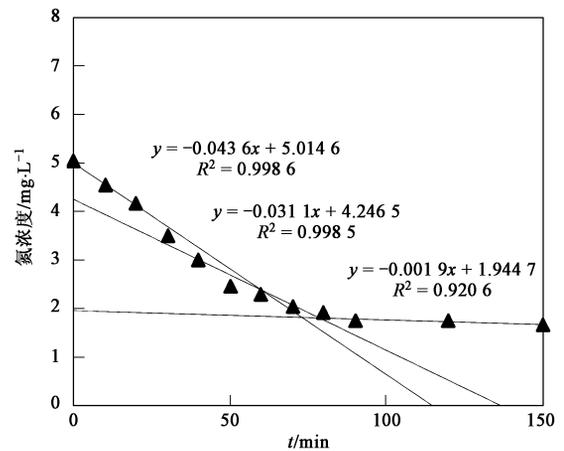
图6 LAS NUR 曲线图(25 mg L<sup>-1</sup>)
