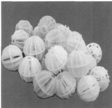
图 2 小试试验填料实物示意
