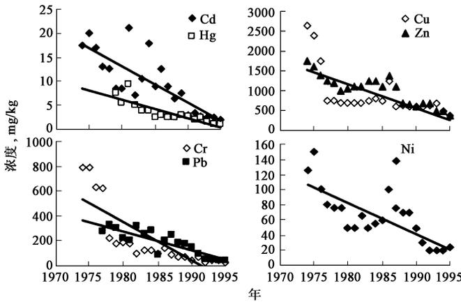
图2 挪威 Bekkelaget 污水处理厂城市污泥中重金属含量的变化趋势
