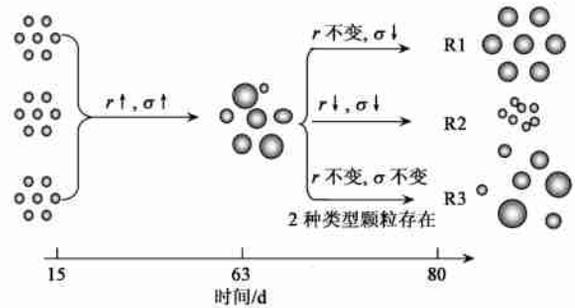
图 6 不同含盐条件下颗粒污泥的粒径演替过程
