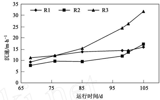
图3 污泥颗粒沉速变化曲线
