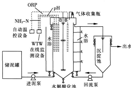
图 1 初沉污泥水解酸化工艺流程
