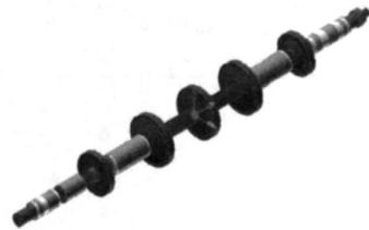
图 2 实验转子的三维模型
