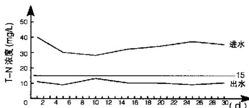
图 5 四厂 2002 年 3 月进、出水 T- N 变化曲线
