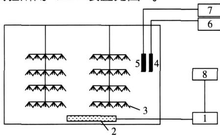
1.充氧泵 2.砂头 3.填料 4.DO 探头 5.pH 探头
