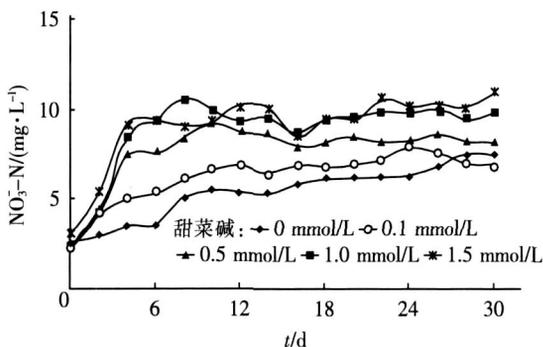
图 5 投加甜菜碱对去除  $\text{NO}_3^- - \text{N}$  的影响
