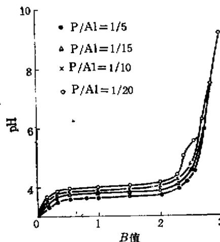
图 2 Al(III)溶液的碱滴定曲线
