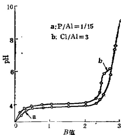
图 1 Al(III)溶液的碱滴定曲线
