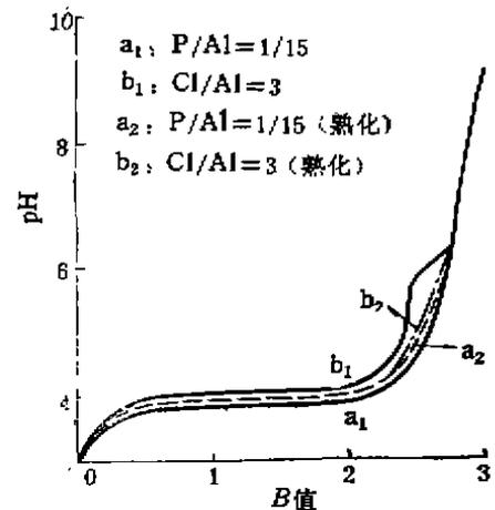
图 3 熟化 24h 后 Al(III)溶液的 pH 变化情况
