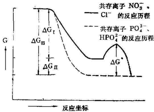
图 9 沿反应坐标自由能的变化示意图
